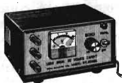
Fig. 12 - L'alimentatore stabilizzato è uno degli apparati più importanti per la professione del radioriparatore. Deve essere di tipo regolabile, con tensione variabile fra i 3 V e i 15 V e con possibilità di assorbimento di corrente minima di 0,7 A.
